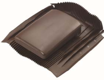
Tuile de ventilation universelle en PVC avec manchon de raccordement (ne pas connecter sur des chaudières) Plaque de base composée de - plaque de base souple - chapeau (couleur noir, rouge ou brun) - adaptateur diamètre 112 ou 125 mm
