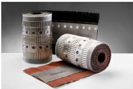
Sous-faitière Eterroll – pour faitières et arêtières Couleur anthracite et brun-rouge Longueur du rouleau 5 cm Largeur du rouleau 31 cm
