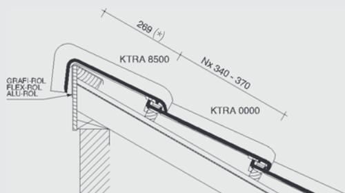
**Plan de pose transversale de la toiture au niveau de la tuile de rive (modèle allemand)**
