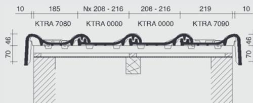
**Plan de pose longitudinale de la toiture au niveau de la tuile membron**
