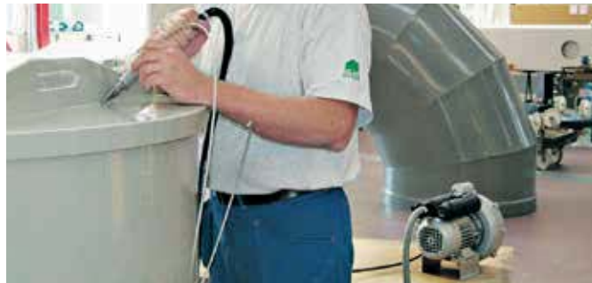
ROBUST-blazer als luchtvoorziening voor de WELDING PEN.
