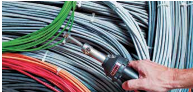
Aanbrengen van een gesoldeerde krimpverbinding met behulp van de HOT JET S en opgeschoven zeefreflector.
