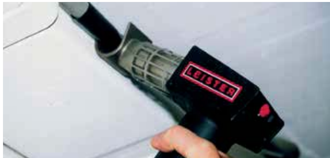
Het krimpen van gevlochten kabeladers met de GHIBLI.
