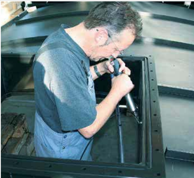
DIODE S toegepast bij trekassen van een detail van een tank.
