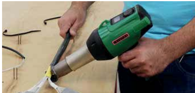
Krimpen bij het confectioneren van kabels – ideaal met de GIBLI AW
