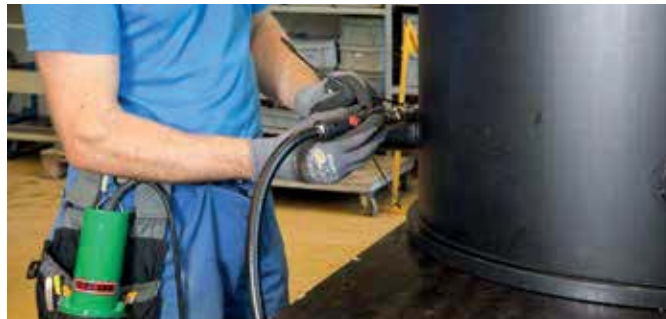
LABOR S gekoppeld met de MINOR als externe luchtvoorziening.
