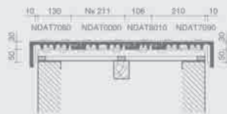
Plan de pose transversale de la toiture au niveau de la tuile de rive
