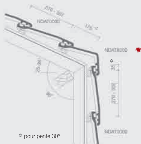
Plan de pose longitudinale de la toiture au niveau de la tuile faitière
