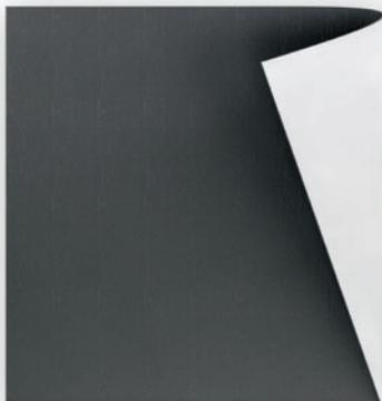
Le ZINC PLUS est recouvert en sous-face d'une couche de protection blanche de composition organique. Cette couche de protection fait l'objet d'un brevet. L'épaisseur totale de la couche est d'au minimum 60 micromètres. Cette couche de protection en sous-face du zinc ne nécessite plus l'aération du complexe sur lequel est posé le ZINC PLUS.
