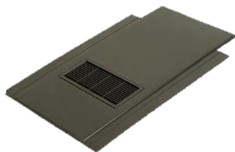
Ardoise universelle d'aération "IN LINE VENT" (ne pas connecter sur des chaudières) - HIPS gris foncé 600x300 mm - surface d'aération 10000 mm² - la pièce d'évacuation inclus
