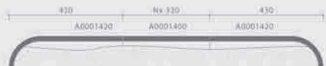
Plan de pose transversale de la toiture au niveau de la faîtière posée au mortier 1400
